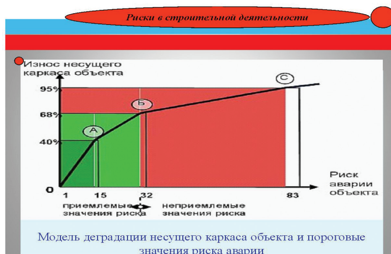
Рис. 2. Модель деградации несущего каркаса объекта и пороговые значения риска аварии [10]
